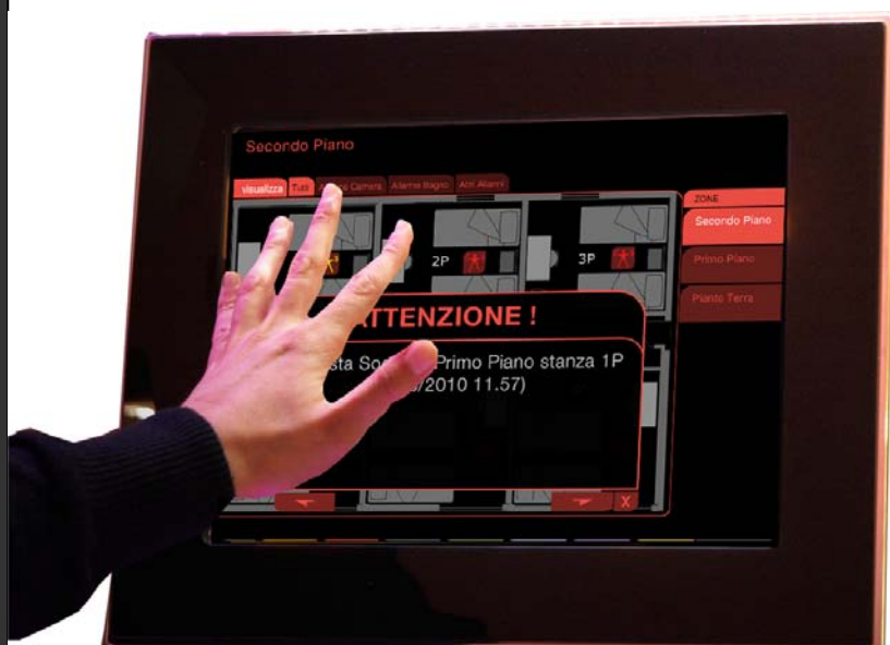
Supervisione e gestione Allarmi da touch screen (5'-15')
