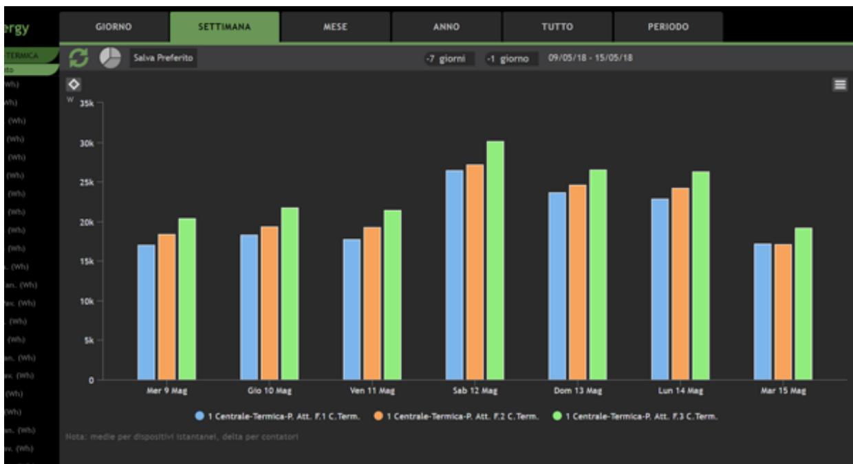
**Hi.Energy si occupa della registrazione dei dati provenienti dal campo** e può acquisire fino a 10.000 punti di misura (temperature, consumi energetici, dati di diagnostica, ecc.) che vengono raccolti **in un database storico ed elaborati in formato grafico**. I dati
